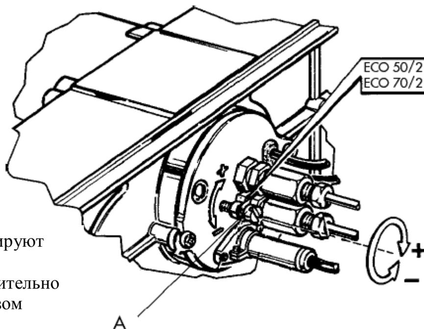
С помощью винта А регулируют положение линии форсунка/дефлектор относительно сопла, изменяя таким образом сечение прохода воздуха.
