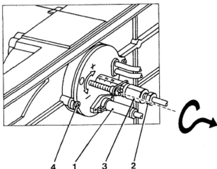
После снятия кожуха, отсоединить провода высокого напряжения от трансформатора, свинтить фоторезистор **1**, отвинтить штуцер **2**, который соединяет топливный трубопровод с линией **3** форсунки, (горелки ESO 30/2 – ESO 40/2 имеют по **2** штуцера), отпустить винты **4** и, вращая фланец по часовой стрелке, извлечь сборку фланец – форсунка – дефлектор – электроды.
