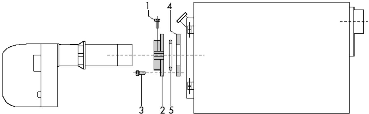
Закрепить фланец **2** на котле с помощью 4-х винтов **3**, проложив изоляционную прокладку **4** и изолирующее кольцо **5**. Вставить горелку во фланец так, чтобы форсунка вошла в камеру горения в соответствии с указаниями производителя котла. Закрепить горелку, ввернув винты **1**.
