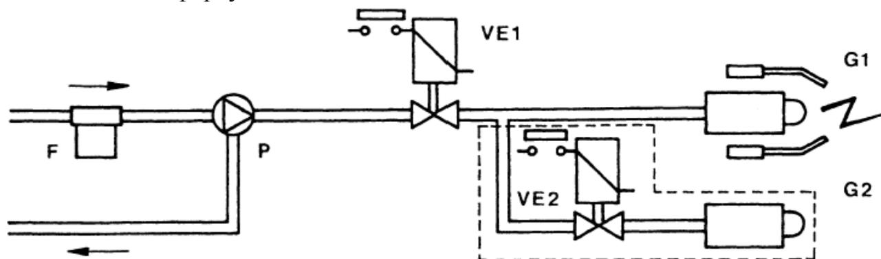
а) После предварительных операций начать цикл запуска. Мотор горелки и насос запускаются, всасываемое дизельное топливо возвращается. Работает горелка и трансформатор розжига, которые выполняют следующие фазы:
