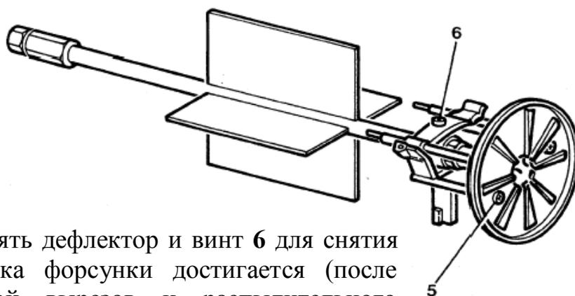
Отвинтить винты **5** чтобы снять дефлектор и винт **6** для снятия электродов. Хорошая очистка форсунки достигается (после снятия фильтра) промывкой вырезов и распылительного отверстия бензином с последующим ополоскиванием дизельным топливом.
