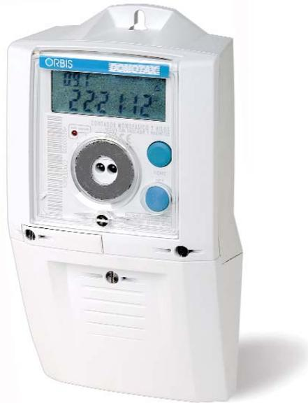
DOMOTAX – однофазный многофункциональный счетчик электроэнергии. Соединение двумя проводами. Прекрасное решение, т.к. заменяет двухтарифный счетчик электроэнергии и счетчик времени. Может включать до 4-х разных тарифов и каждый с максиметром. Опции: RS 232, RS 485, импульсная передача S0, импульсная передача без тарификации.
