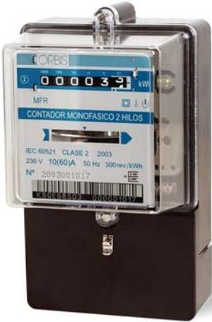
MFR однофазный электромеханический счетчик электроэнергии, класса 2, соединен двумя проводами. Две модели, в зависимости от максимального и рабочего тока: 10(60) А и 15(60) А. Внутренний механизм разработан, чтобы продолжать работать в положительном направлении, даже в случае ошибки связи. Механический дисплей 6 цифр (5+1 десятичная).
